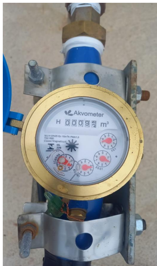
FOTO 1 – Vista de Hidrômetro utilizado nas medições de volume de água
